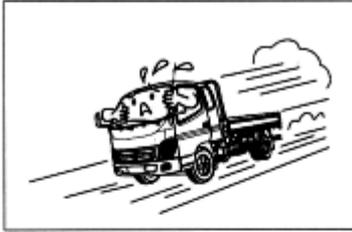
11. Absténgase de apagar el motor durante la marcha. De lo contrario, al no trabajar el compresor, el sistema de aire comprimido perderá presión hasta que, eventualmente, el sistema de frenos dejará de funcionar. Además, si gira la llave en el interruptor de ignición a la posición “LOCK”, el sistema de dirección se inhabilitará y bloqueará y perderá el control del vehículo.
