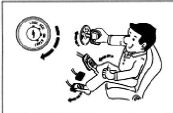
2. Deje trabajar el motor en mínima de 2 a 3 minutos para permitir la adecuada lubricación de las partes móviles del motor y del turbo-cargador, sin acelerar el vehículo.
