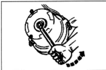
Si su vehículo posee frenos de seguridad, Afloje las tuercas, de 24 mm., de los tornillos de la parte superior trasera de las cámaras de freno, hasta que se libere la ruedas. VER FOTOS
