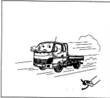
No apoye el pie en el pedal del embrague mientras no lo esté utilizando. Esto con el fin de evitar fricción y desgaste prematuro del mismo.
