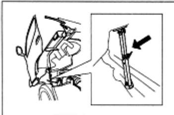
5. Para devolver la cabina a su posición original, hale la manija de cierre y libere la traba de la barra de soporte de la cabina, tire hacia tras la barra de soporte, sostenga el barandal suplementario y retorne la cabina a su posición original.
