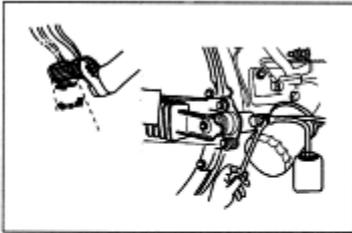
2. Retire la manguera de salida del sistema de embrague.
