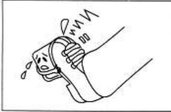
5. No apoye el pie en el pedal del embrague si no lo está utilizando. De lo contrario es posible que el embrague esté trabajando parcialmente causando desgaste en el disco u otros componentes de este sistema.
