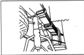
2. Levante el vehículo con un gato hidráulico y sosténgalo con torres de seguridad. Ponga la caja de velocidad en neutro y gire el cardán hasta que se alinee horizontalmente la campana de freno de emergencia ubicada en la parte delantera del cardán.
