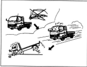
Siempre accione el freno de parqueo independientemente de la inclinación del terreno, con el fin de evitar accidentes por deslizamiento del vehículo.
