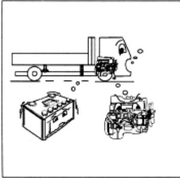
No encienda el motor inmediatamente después de que lo apague. Debe esperar aproximadamente dos minutos, con el fin de evitar daños en las baterías y en el motor de arranque.
