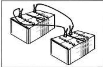
Si la batería se encuentra descargada. Recuerde utilizar una batería auxiliar del mismo voltaje (ver tabla) para iniciar el vehículo.
