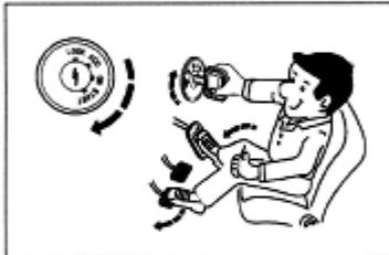
2. Deje trabajar el motor en mínima de 2 a 3 minutos para permitir la adecuada lubricación de las partes móviles del motor y del turbo-cargador, sin acelerar el vehículo.
