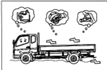
9. Preste atención y evite conducir sobre arroyos o charcos ya que puede ingresar agua al sistema de admisión de aire, caja de cambios y diferencial causando daños graves. Si le entra agua a la caja de cambios o al diferencial, debe drenar completamente el aceite y remplazarlo por aceite nuevo.
